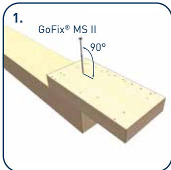
1. Die Lasche wird mittels GoFix MS II Schrauben an der Stütze lagefixiert.
