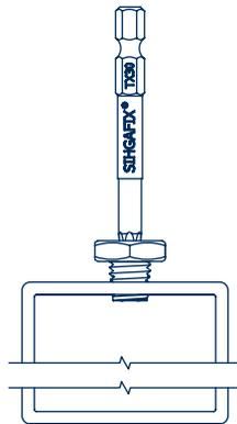
c) Schraube M 5 x 50 A2 mit TX 25 eindrehen
