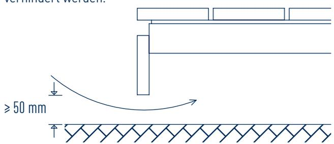
Bei einem seitlichen Abschluss der Terrasse durch ein Abdeckbrett ist eine Zuluft-Öffnung von  $\geq 50$  mm (durchlaufend) für die Belüftung der Terrassenkonstruktion einzuhalten. Das Abdeckbrett soll nicht den Boden berühren.
