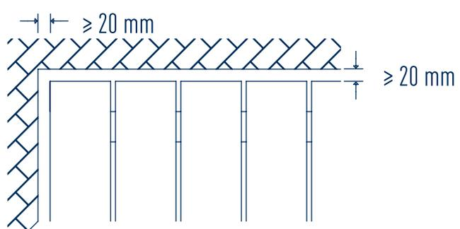
Beim Anschluss der Terrasse an angrenzende Bauteile ist ein Abstand von  $\geq 20$  mm einzuhalten, damit sich die Fugen weder durch Verschmutzungen noch durch Veränderungen der Dielen schließen können. Der ungehinderte Wasserablauf auf und unterhalb der Terrasse muss dauerhaft gewährleistet bleiben.
