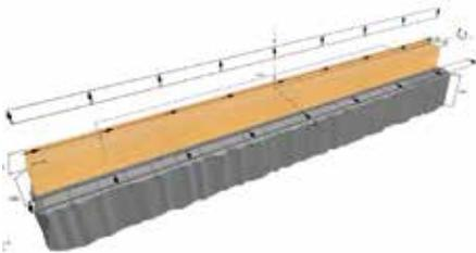
optimierte Dübel-Anordnung; durch die Eingabemöglichkeiten von Linienlasten werden die Befestigungsmittel sofort optimiert angeordnet
